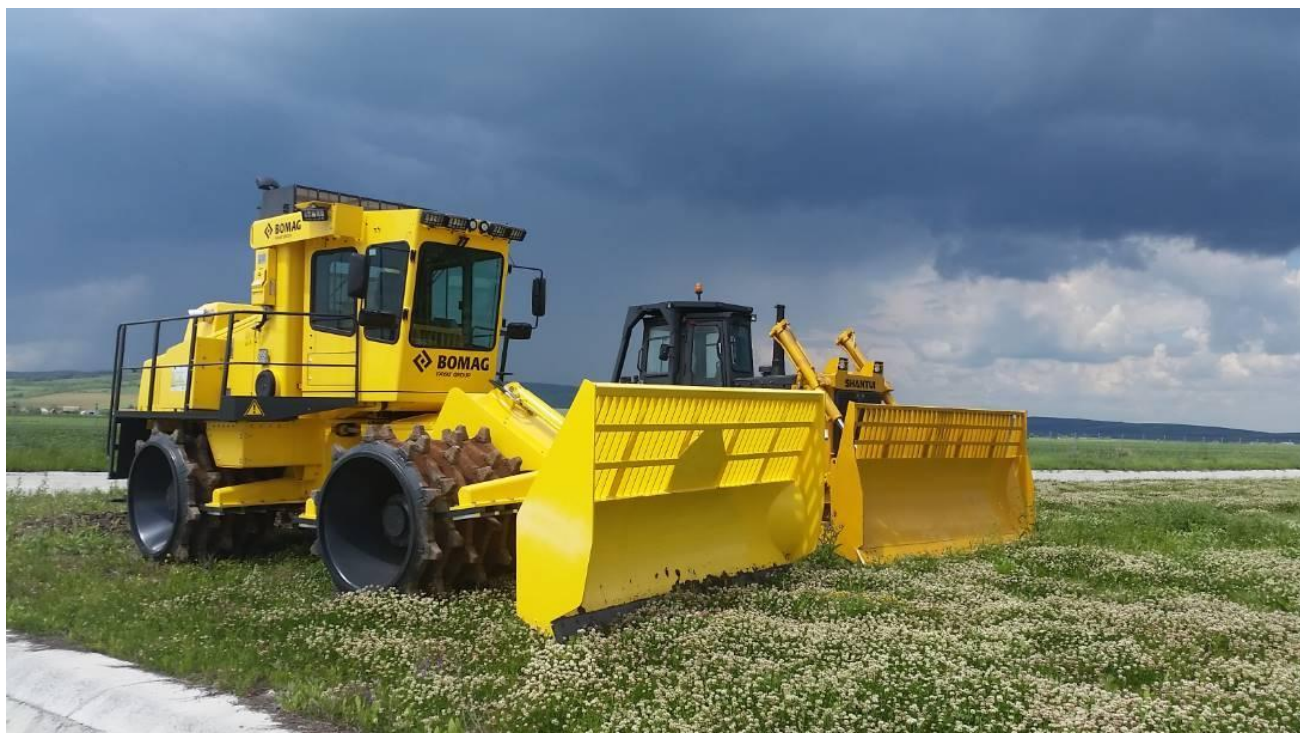
Fig. Nr. 5 - Compactor cu picioare de oaie si buldozer
