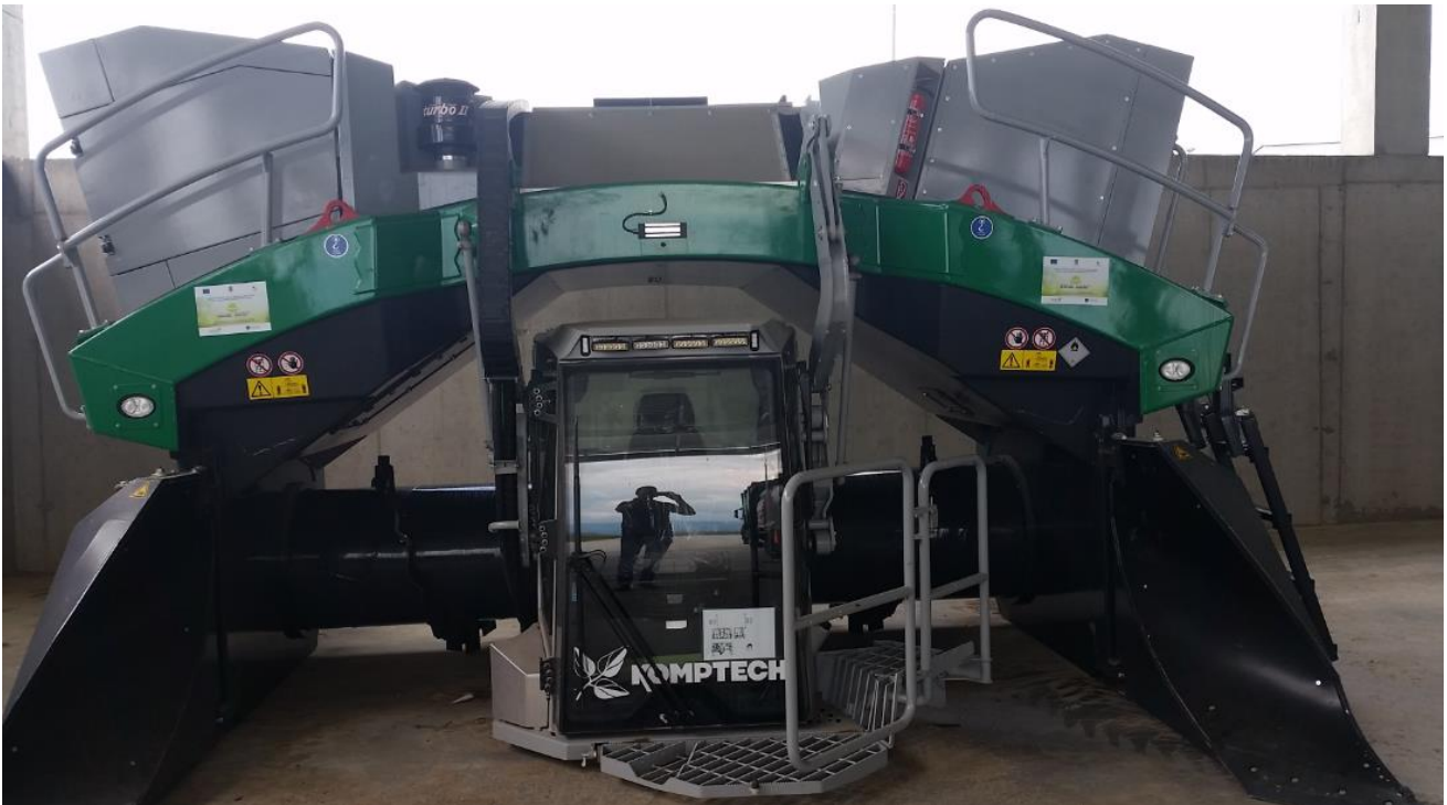
Fig. Nr. 7 - Intorcator de brazde marca KOMPTECH
